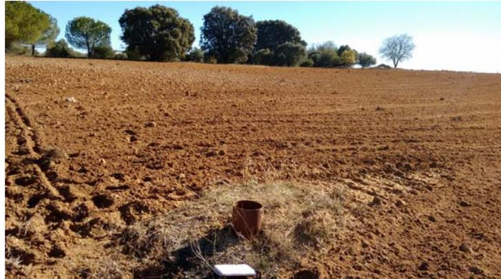
**Figura 3.** Piezómetro
