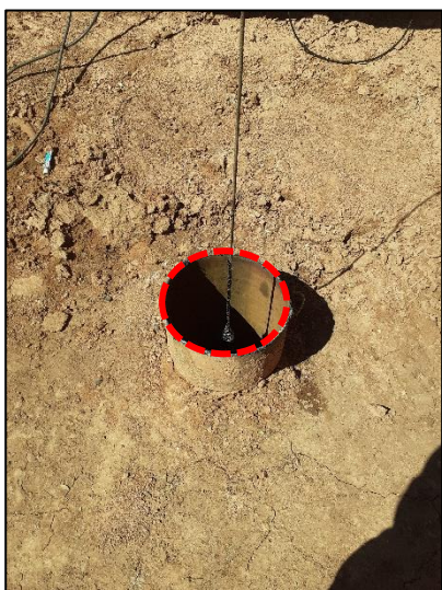
Figura 21. Inicio del reconocimiento videográfico del sondeo tras el Aqua Freed.
