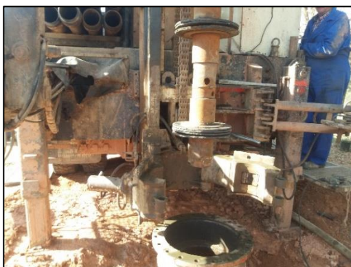
Figura 15. Doble obturador de swabbing.
