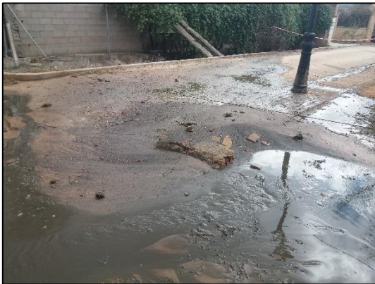
Figura 19. Material arenoso y óxidos extraídos del fondo del sondeo, entre los metros 60 y 69.
