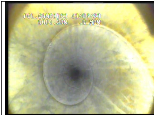
Fotografía 2.- Visión axial. Inicio del reconocimiento videográfico.
