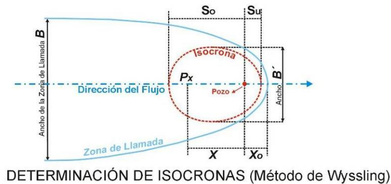
**Figura 8.** Método de Wyssling para el cálculo del tiempo de tránsito
