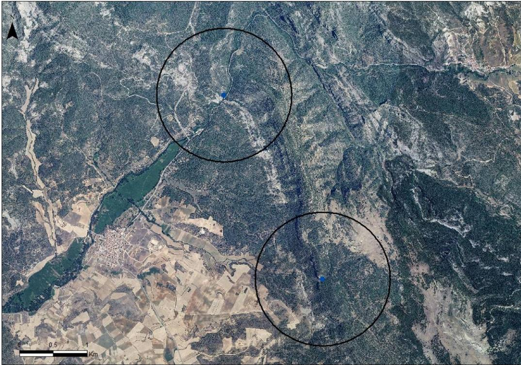
**Figura 14.** Perímetros de protección de la cantidad en los dos manantiales de abastecimiento a Cañamares.
