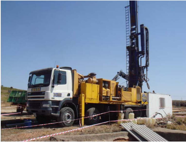
Fotografía 1. Sonda de rotopercusión. Modelo SEGOQUI 1900.
