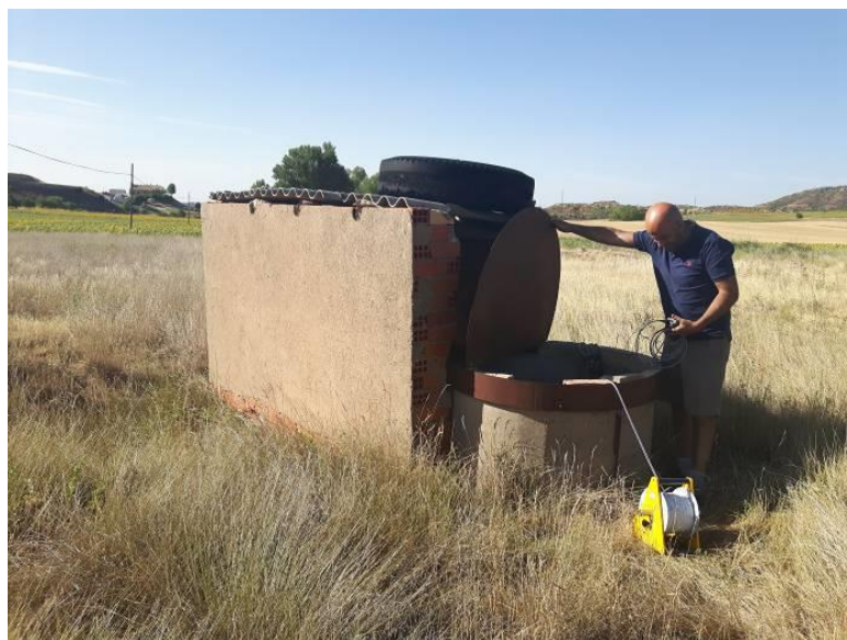
Foto 2. Punto de control. Nivel Piezométrico: 4,10 metros.
