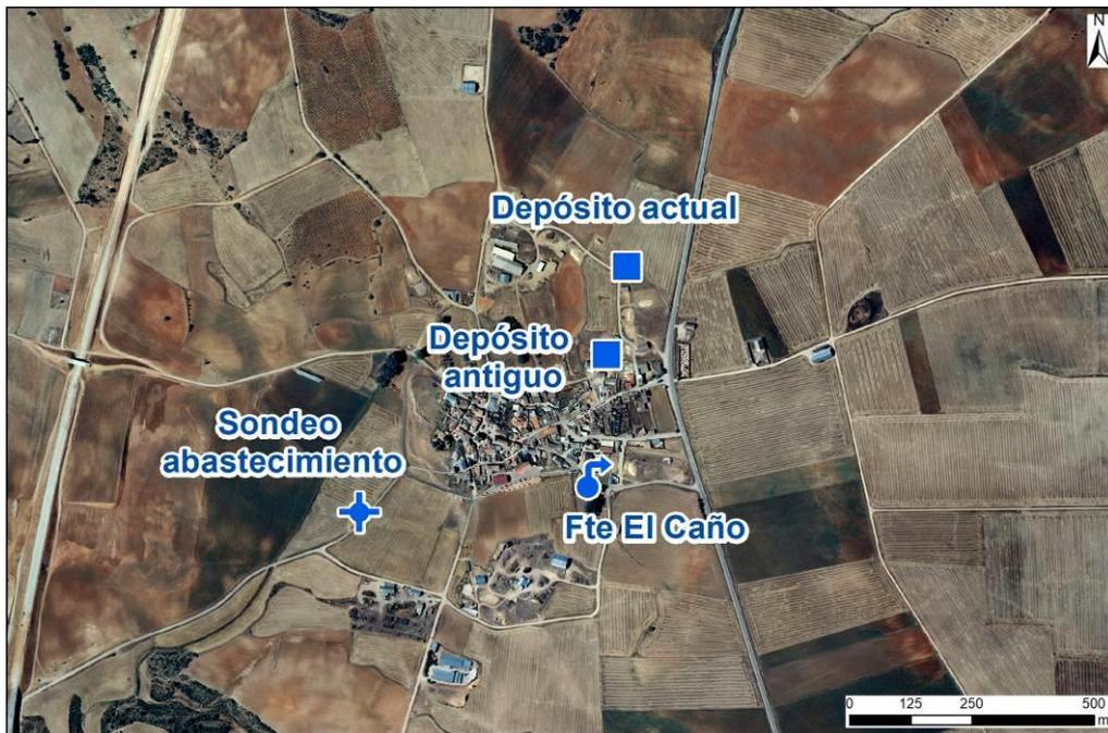
Figura 6. Elementos del sistema de abastecimiento de Gabaldón sobre ortofoto
