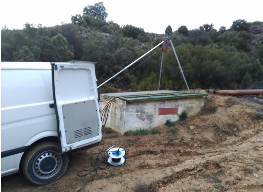
**En la siguiente fotografía se puede observar el equipo de testificación geofísica utilizado junto al sondeo:**
