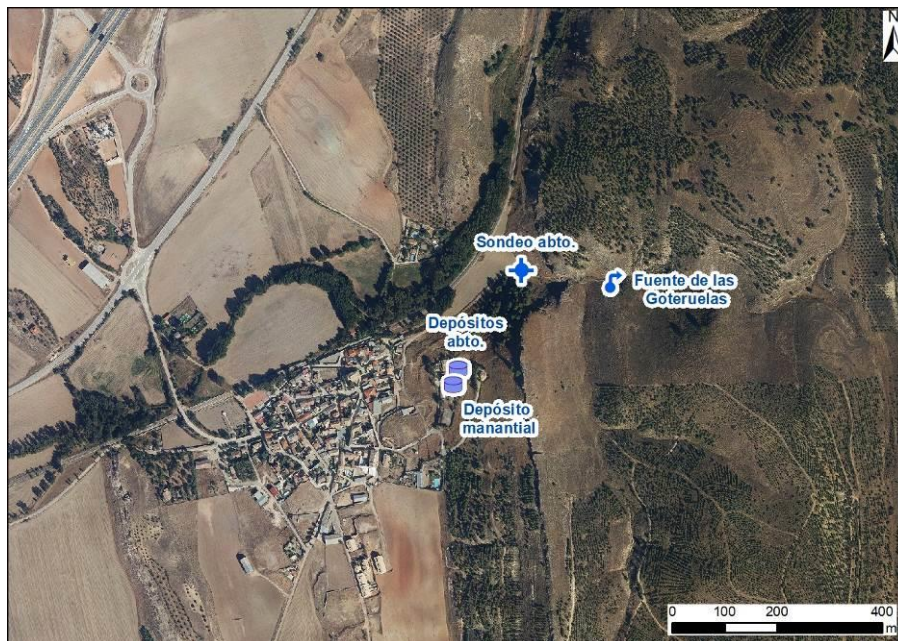
Figura 5. Elementos del sistema de abastecimiento sobre ortofoto
