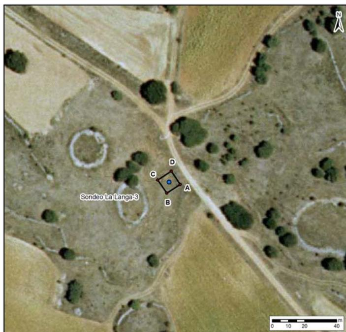
**Figura 9.** Mapa de la propuesta de zona de restricciones absolutas del perímetro de protección en el sondeo La Langa-3.
