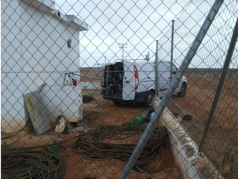
Fig. 1. Equipo de testificación geofísica utilizado junto al sondeo.
