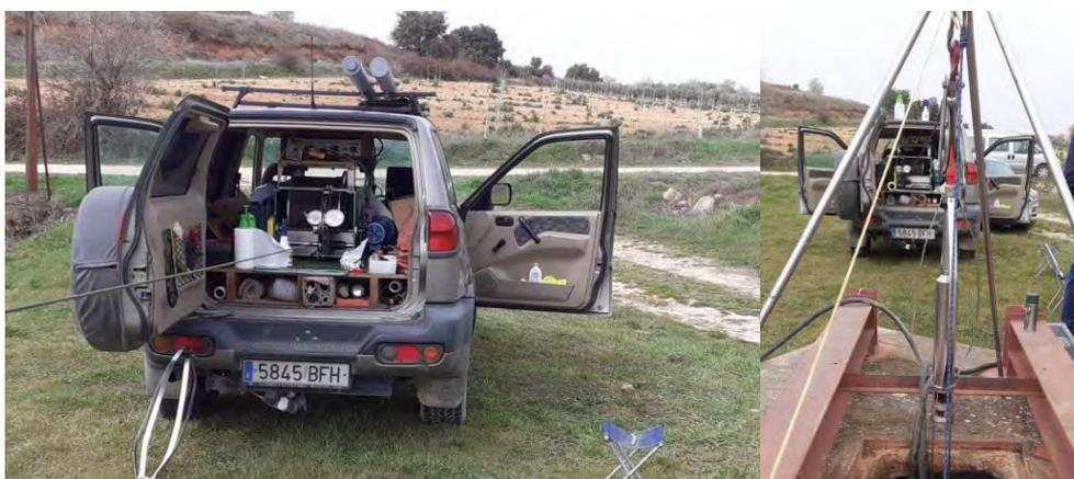
Figura 2.- Realización de testificación geofísica en el Sondeo de Abastecimiento a San Lorenzo de la Parrilla.
