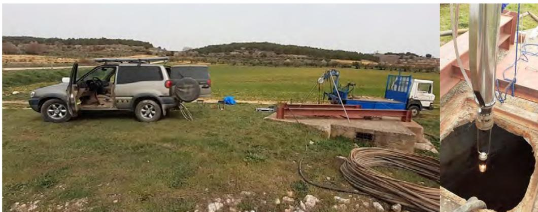
*Figura 8.- Realización del registro videográfico y testificación geofísica en el Pozo de Abastecimiento a San Lorenzo de la Parrilla.*
