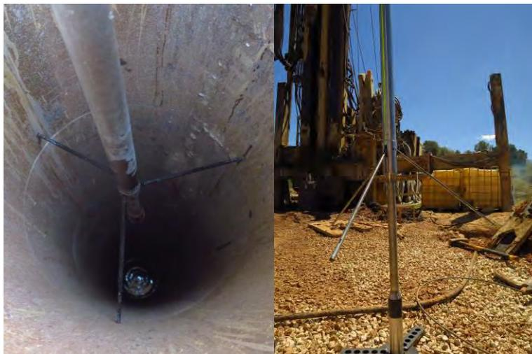
*Figura 6.- Sonda Cáliper QL40-CAL utilizada en el registro.*
