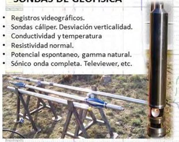
La **metodología de trabajo**, consiste en conectar una determinada sonda paramétrica a través del cable coaxial de 1/4", dependiendo de los objetivos del estudio y descenderla por el interior de la captación. El sondeo, debe estar accesible y libre de todo el equipamiento electromecánico (bomba, tubería de impulsión, etc.).
