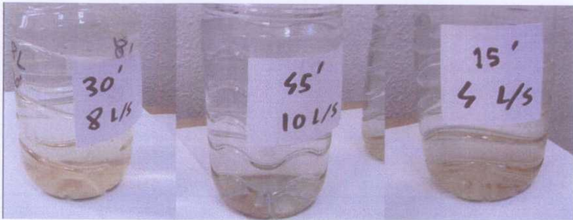
Foto 1.- Muestras tomadas durante el aforo con 8, 10 y 4 L/s a 30', 45' y 15' respectivamente.
