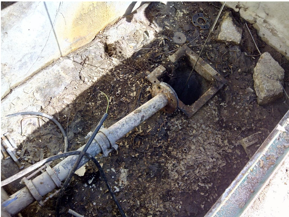
Fotografía del brocal del sondeo.
