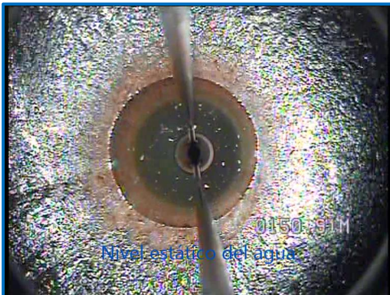
Nivel estático del agua, visto desde 150,91 m
