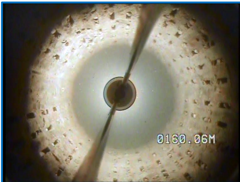
Detalle filtro troquelado, 160,06 m
