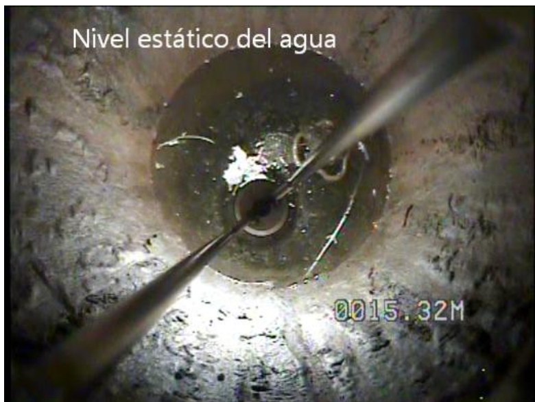
Nivel estático del agua, visto desde 15,32 m
