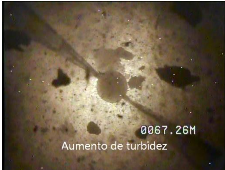
Aumento de turbidez y partículas en suspensión, 67,26 m
