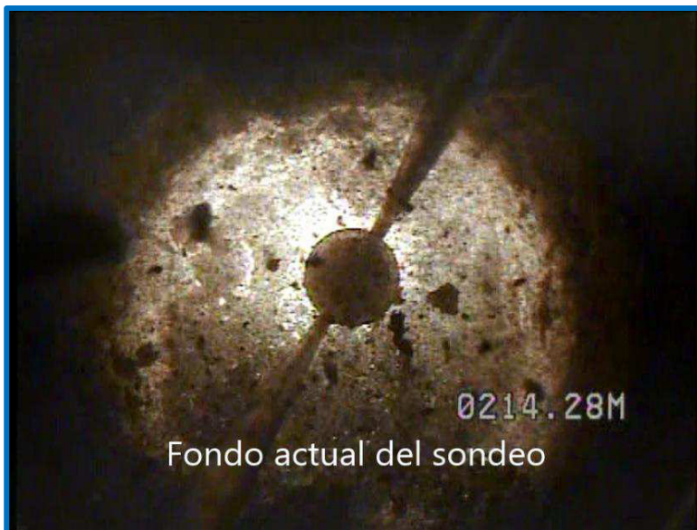
Fondo actual del sondeo, situado a 214,5 m
