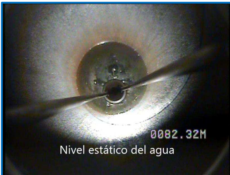
Nivel estático del agua, visto desde 82, 32 m
