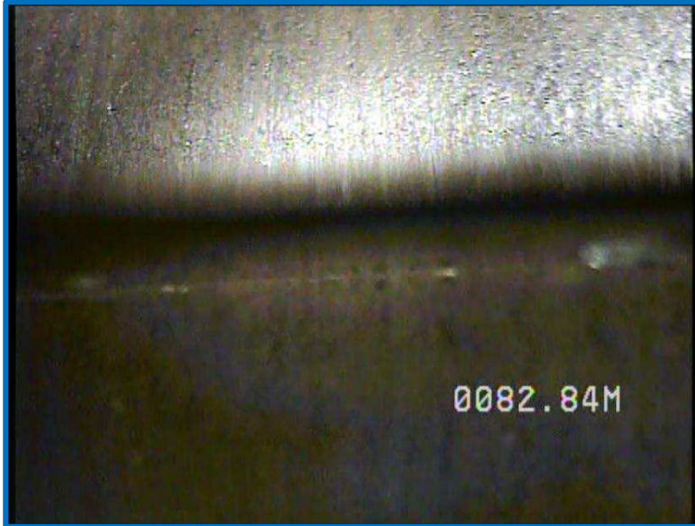
Nivel estático del agua, situado a 82,84 m, ligera turbidez
