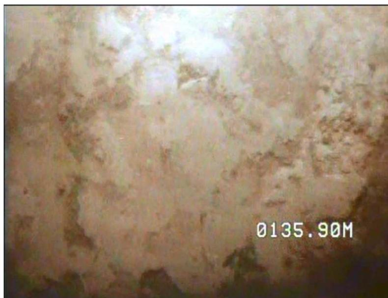
Foto 2.\_ Rotura tubería de revestimiento.
