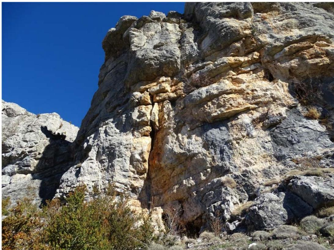
Figura 30. Fractura subvertical abierta que afecta a la totalidad del escarpe en la zona D. Obsérvense las manchas de alteración propias de circulación de agua en su interior
