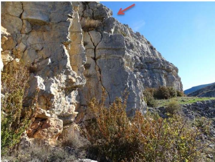
Figura 23. Grieta abierta en el frente de la zona B que individualiza un gran bloque prismático que puede caerse por vuelco o socavación de la base. Obsérvense los pequeños bloques sueltos situados encima que podrían desprenderse a la vez.
