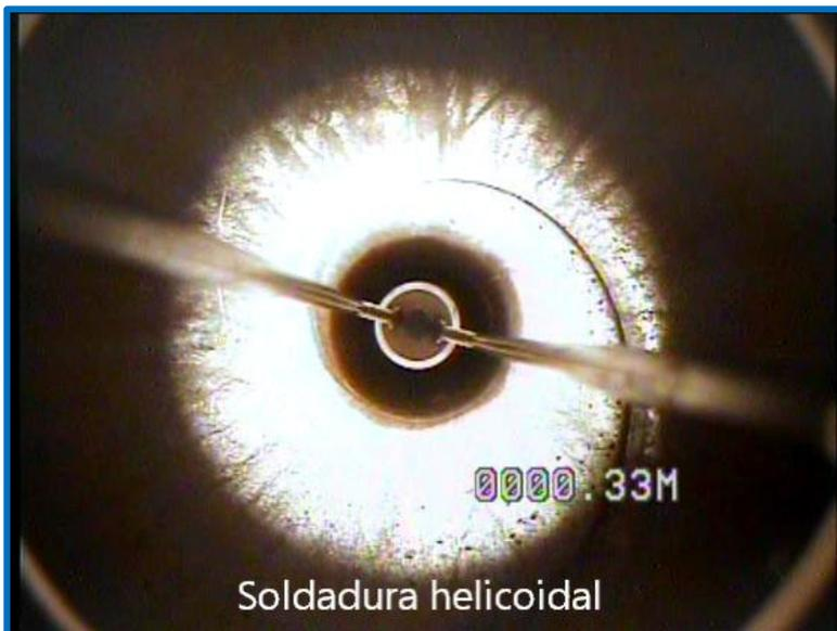
Tubería de acondicionamiento tipo soldadura helicoidal, 0,33 m
