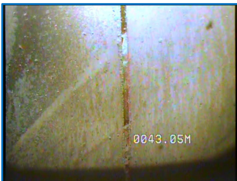
Detalle de otra ranura 43,05 m.
