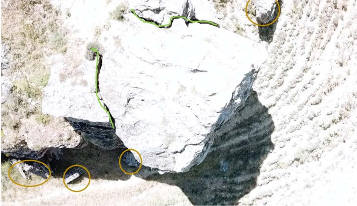
**Figura 29.** Vista cenital de la roca. Extracto de un video tomado con dron (16/06/2019). Son frecuentes los bloques de tamaño métrico en la zona de pie arcillosa. Las líneas en verde identifican grietas verticales por efecto del descalce en la zona de pie.
