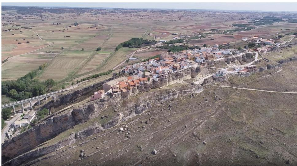
**Figura 4.** Vista aérea de la población de Zafra de Zancara orientada hacia el este. En la parte superior de la ladera suroeste del cerro se observan dos escarpes subverticales de materiales carbonatados desde los que se producen caídas de bloques que tapizan la ladera. En la parte izquierda de la foto se observa el acueducto del Tránsito Tajo-Segura
