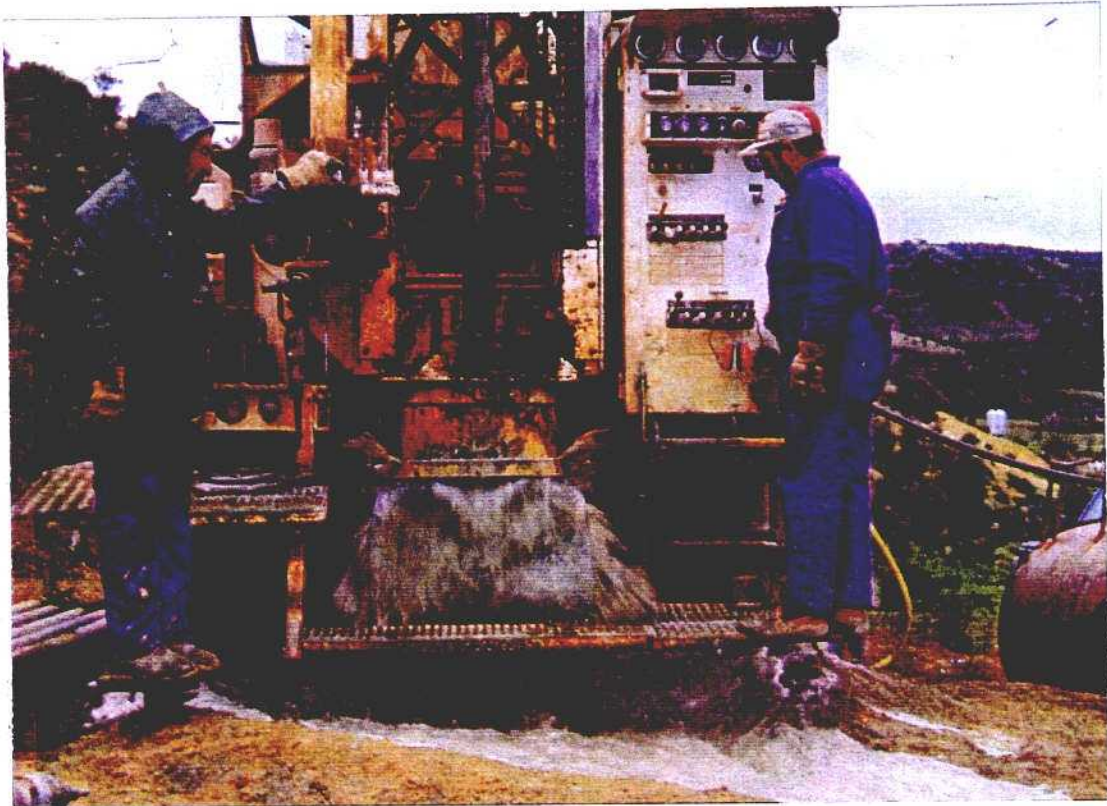
Foto 2- Perforación del segundo sondeo de Zafrilla. Obsérvese el caudal al soplar.
